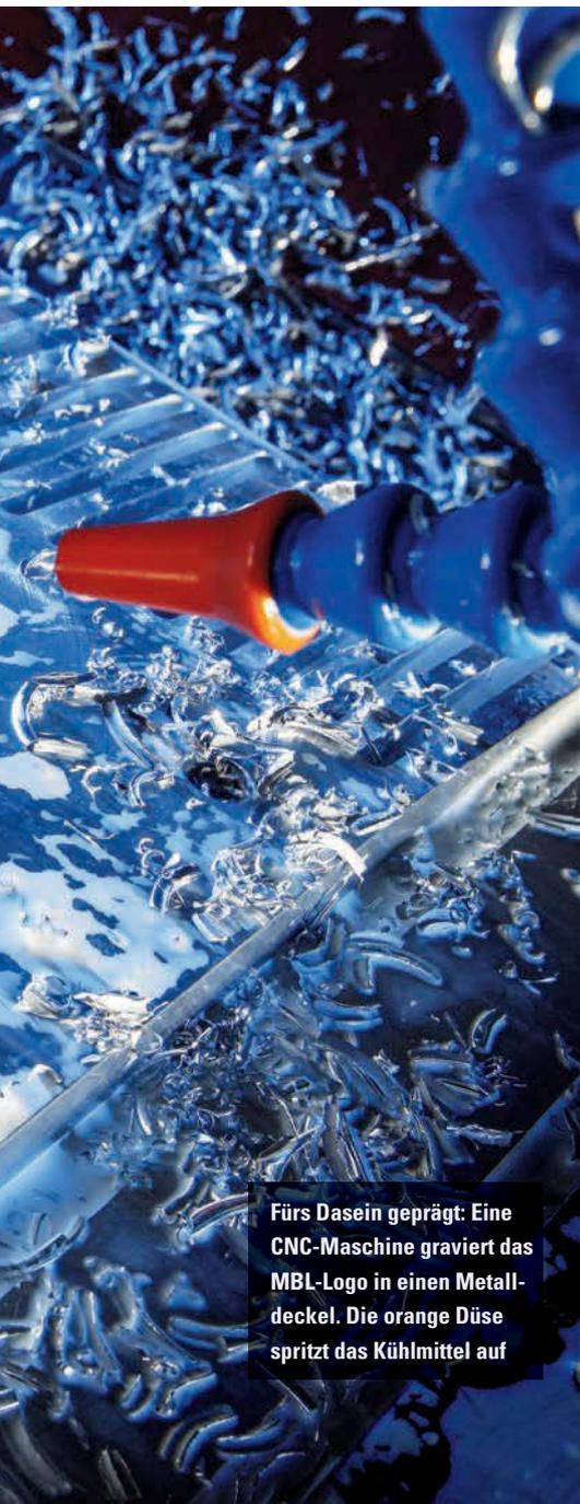
Fürs Dasein geprägt: Eine CNC-Maschine graviert das MBL-Logo in einen Metalldeckel. Die orange Düse spritzt das Kühlmittel auf
