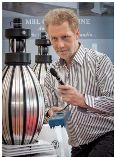
Der Frequenzgang der einzigartigen Radialstrahler muss zu den Höhen hin leicht abfallen
